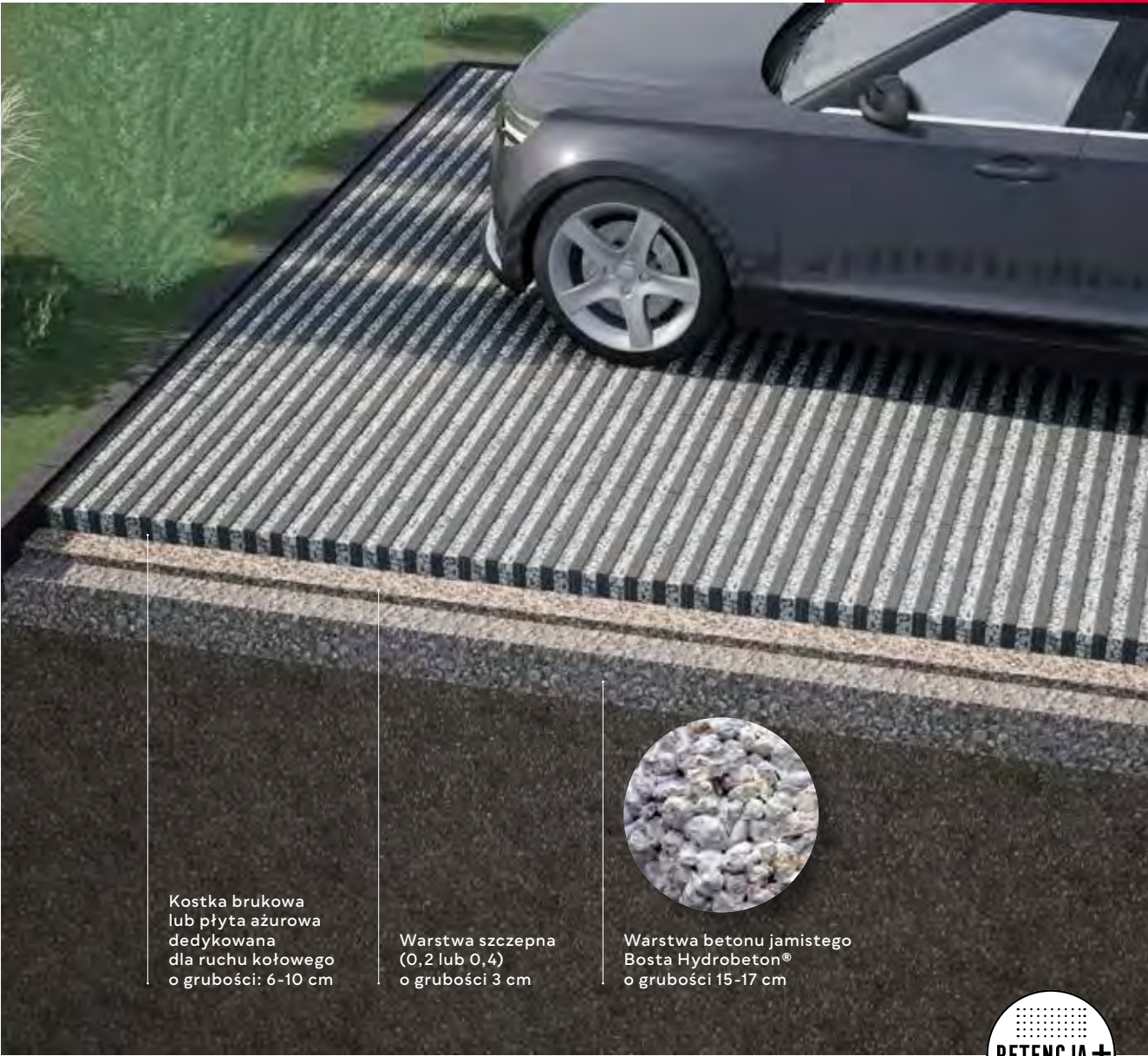
Przykładowe zastosowanie rozwiązania nawierzchni przepuszczającej wodę: drogi wewnętrznej, placu lub stanowisk postojowych dla pojazdów o masie poniżej 2,5 tony | Retencja+ przy ułożeniu wzorowanym na wizualizacji |
